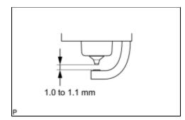
(d) Check the spark plug electrode gap.
