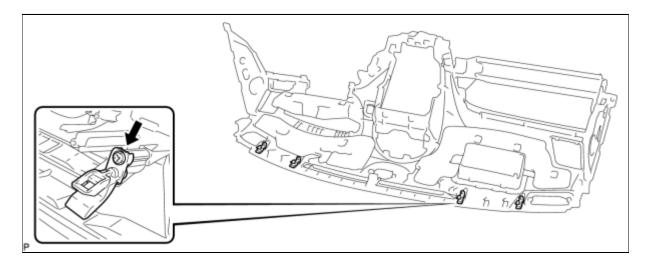
4. INSTALL FRONT PASSENGER AIRBAG ASSEMBLY
