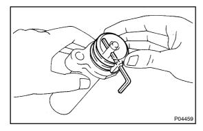
(d) Install the dust boot onto the tensioner.
