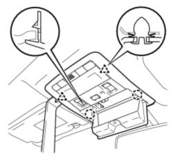
(d) Using a moulding remover, disengage the 2 claws and 2 clips.
