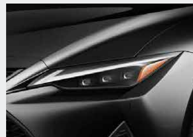
三眼フルLEDヘッドランプ(ロー・ハイビーム)& LEDフロントターンシグナルランプ IS350 IS300h IS300
