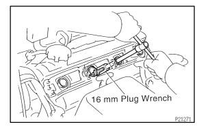
(d) Using a 16 mm plug wrench, remove the spark plug.
